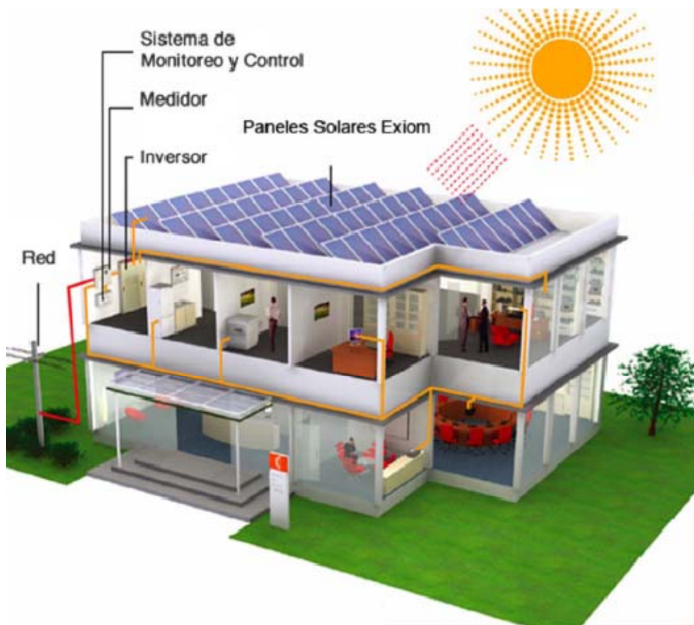
Figura 4.1. Esquema de un sistema fotovoltaico de conexión a red interior.
